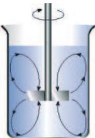
**Flujo Radial**, incidencia gráfica de agitación en el medio. Agrupa los rotores cuyas aspas están en paralelo con el eje de agitación. (Rotores tipo pala, áncora).
