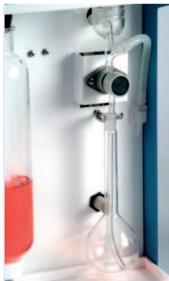
El dispositivo de paro automático finaliza la destilación antes de alcanzar los 200 ml de destilado. Mediante la función ADD se pueden añadir pequeñas cantidades de destilado hasta completar el enrase del matraz, sin añadir agua ajena a la destilación.
