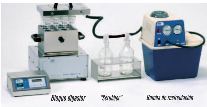
Bloque digestor "Scrubber" Bomba de recirculación
