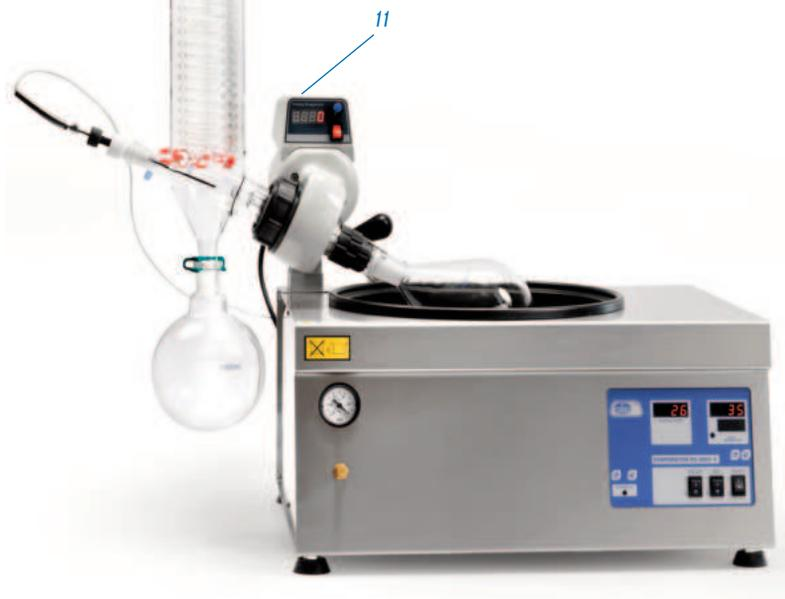
1. Indicador con lectura digital de la temperatura de la sonda externa.
