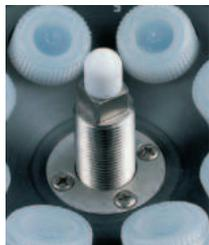
**Sensor de identificación de cabezal (solo en los modelos "Centronic BLT" y "Centrofriger BLT")**, que al cerrar la tapa de la cámara del rotor, comunica al microprocesador todos los límites de funcionamiento del cabezal, evitando así antes de la puesta en marcha cualquier riesgo de fallo en el momento de la programación de dichos parámetros. Este sistema es un método abierto de identificación que permite la posibilidad de ampliar la
