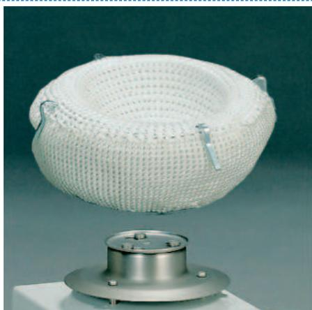
Agitador y manta con dispositivo adaptador.
