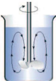
**Flujo Axial**, incidencia gráfica de agitación en el medio. Agrupa los rotores cuyas aspas presentan un ángulo inferior a 90° respecto al eje de agitación. (Rotores tipo hélice).
