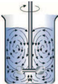
**Flujo Radial Dinámico**, incidencia gráfica del principio cónico en el medio de agitación. Agrupa toda la serie de rotores Visco-Jet®. Excelentes resultados y de mínimo consumo.
