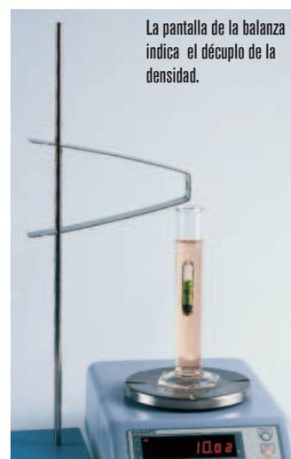
La pantalla de la balanza indica el décuplo de la densidad.
