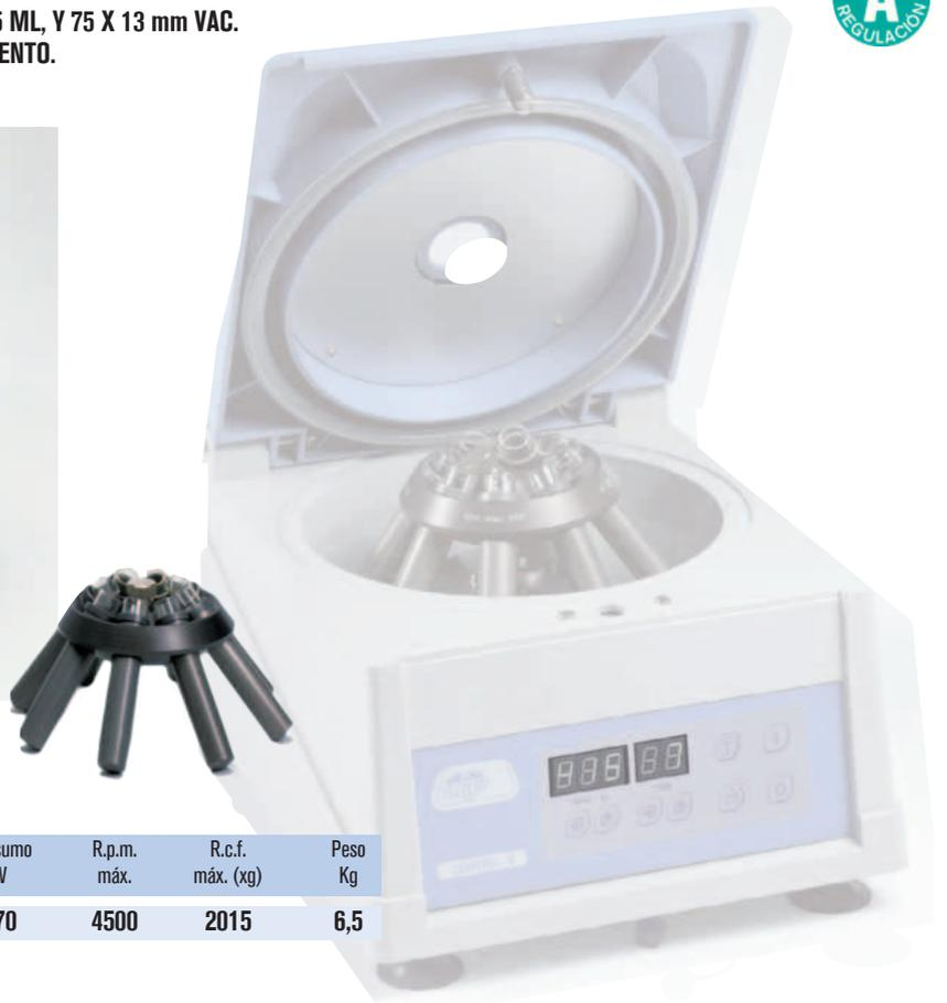
Mueble exterior moldeado en plástico técnico en ABS.
