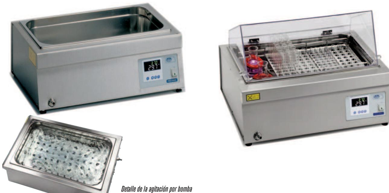
*Detalle de la agitación por bomba de circulación interna.*
